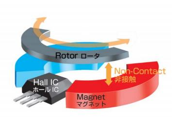
RSM12CはホールICを使用した小型の非接触方式角度センサです。 独自の磁気回路設計により、薄型基板実装タイプの小型非接触角度セン
